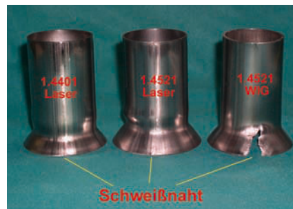
Abb.6 Aufweitproben im Vergleich, Laserschweißung bei 1.4401 und 1.4521 ideal, die WIG-Schweißung 1.4521 mit Riss durch Kornvergrößerung
